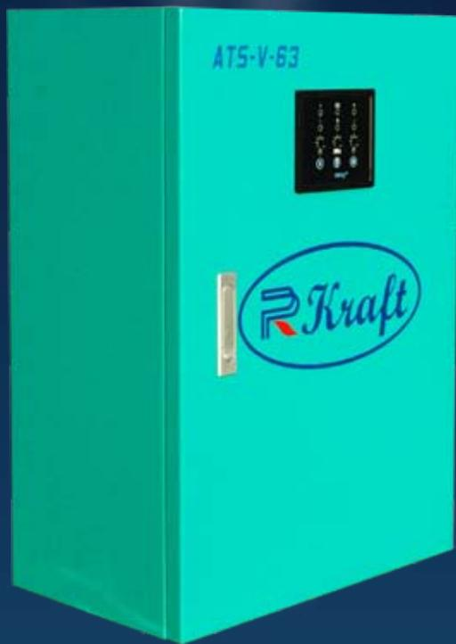
**АВР АТС-V** – это автоматический переключатель нагрузки с модулем управления и контроля линий электроснабжения. АВР осуществляет мониторинг сети и при нарушении электроснабжения подает сигнал на панель управления, которая запускает дизельную электростанцию, после чего переключает нагрузку объекта на питание от резервной электростанции. При восстановлении напряжения в сети алгоритм протекает в обратном направлении. АВР может работать совместно с любой панелью начиная с ВЕ24 и старше.
